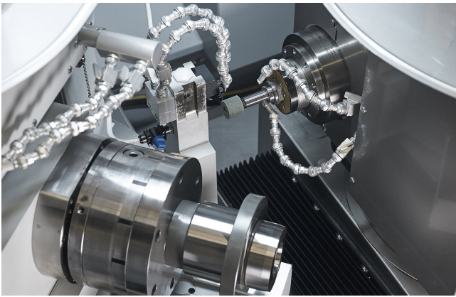
4 Auf der Voumard 1000 kommt ein patentiertes Abrichtkonzept zum Einsatz © Kellenberger
